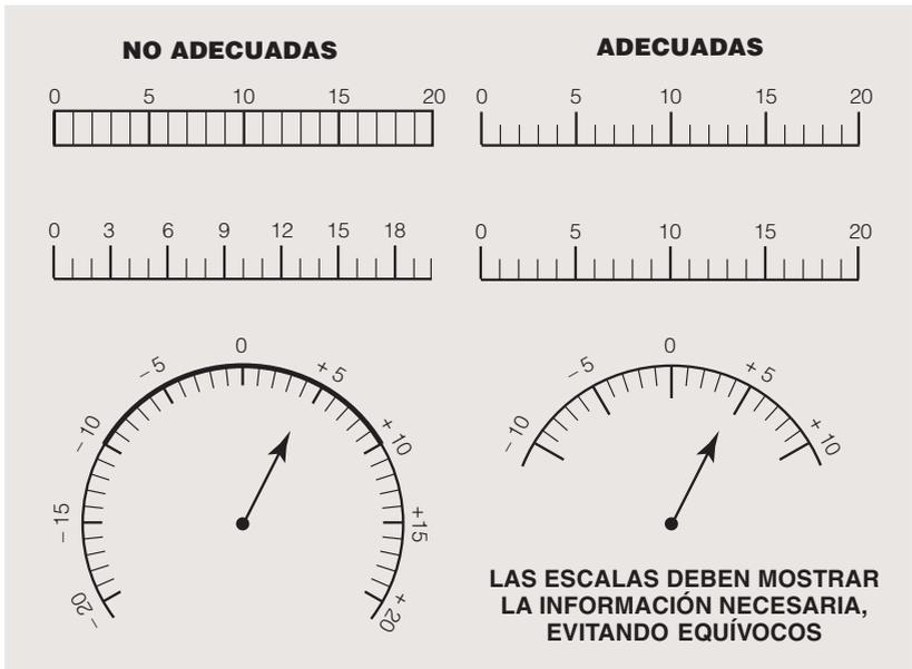
Puede resultar útil añadir marcas para indicar rangos en los que se debe realizar una operación o que no deben ser sobrepasados, por ejemplo temperatura o presión, y utilizar códigos de colores (rojo para una situación inaceptable, verde para situación aceptable).
